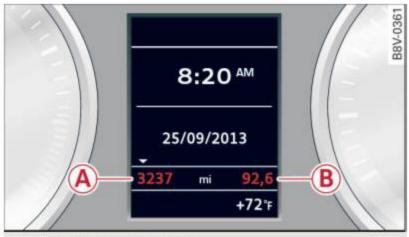
Fig. 10 Display: odometer
